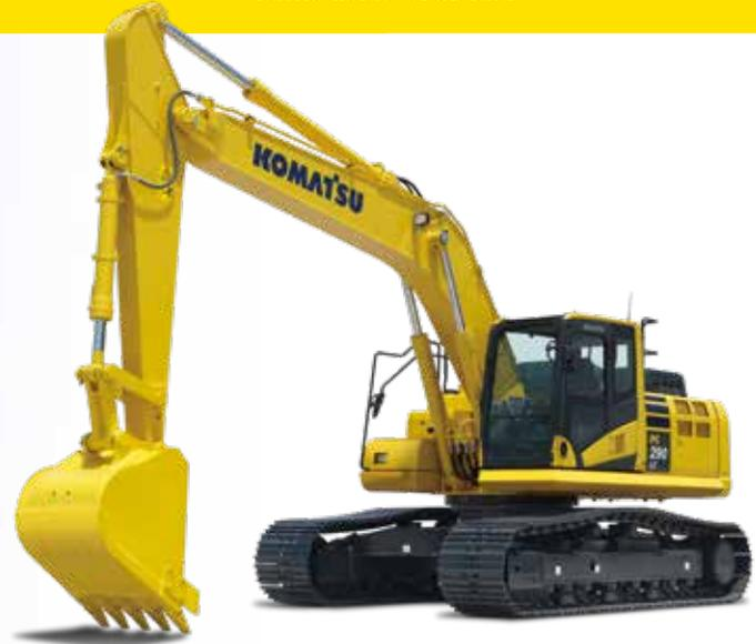
Un puissant moteur Komatsu SAA6D107E-3 fournit une puissance nette de sortie de 147 kW **196 hp**. Ce moteur est certifié EPA Tier 4 (final) pour le contrôle des émissions polluantes.
