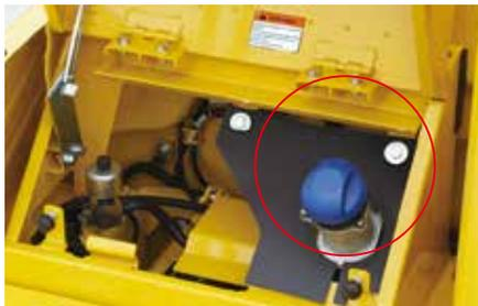
l'accès. Le réservoir et la pompe de DEF sont séparés afin de pouvoir y accéder plus facilement lors d'un service d'entretien.
