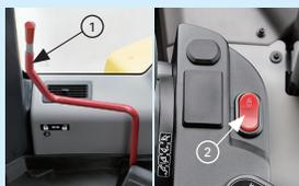
Commutateur secondaire d'arrêt du moteur
