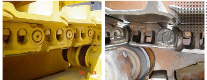
Vous pouvez facilement mesurer la hauteur des maillons à l'aide d'une règle de métal et un ruban à mesurer convexe. En vous basant sur les mesures, vous pouvez calculer le pourcentage de durée de vie. Conseil de pro : Si l'usure de la hauteur du maillon est inférieure à 60 % de l'usure du diamètre extérieur de la bague, une rotation des goupilles et des bagues est recommandée.
