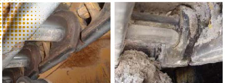
L'usure des bagues est généralement plus rapide que l'usure de la hauteur des maillons et elle devient le critère pour la plupart des cas de remplacement de l'assemblage du train de roulement à maillons. Par conséquent, il est impératif de vérifier régulièrement l'usure des bagues dans le cadre d'un entretien du train de roulement adéquat.
