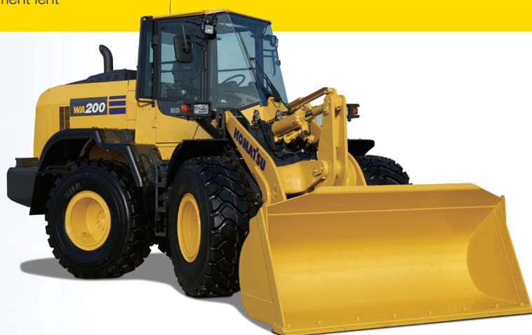
Un puissant moteur Komatsu SAA4D107E-3 fournit une puissance nette de 94 kW **126 HP** avec une consommation de carburant améliorée de jusqu'à 4 %. Ce moteur est conforme aux normes d'émissions EPA Phase 4 finale.
