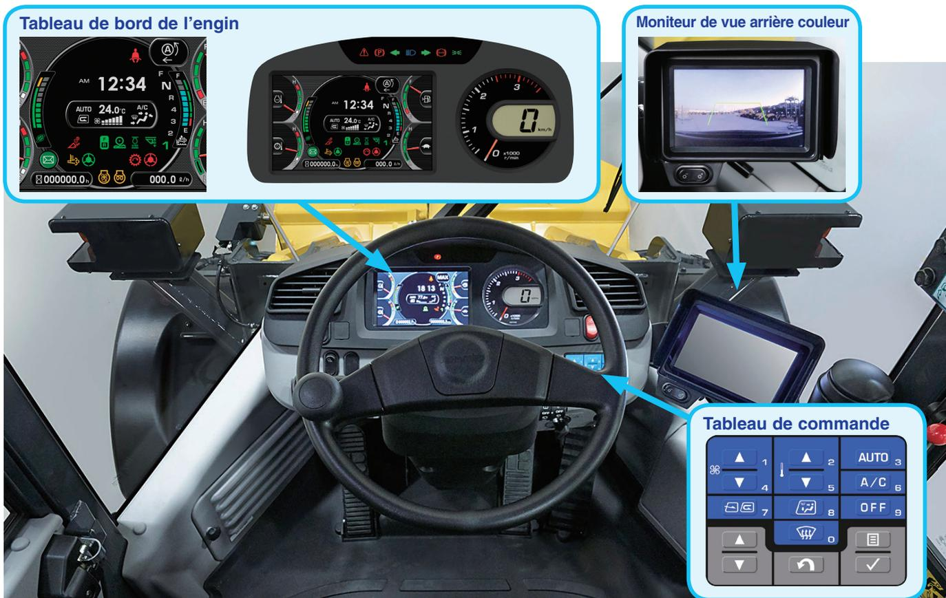
**Système de contrôle visuel arrière standard**
