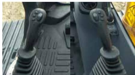
Composants de commande intelligente de l'engin de Komatsu installés en usine.
