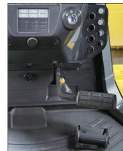
**Mode Décélération :** La pédale module les régimes du moteur et la vitesse de déplacement du véhicule. Elle peut être utilisée pour toutes les applications.
