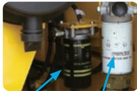
Filtere à carburant haute efficacité    Préfiltere à carburant (avec séparateur d'eau)
