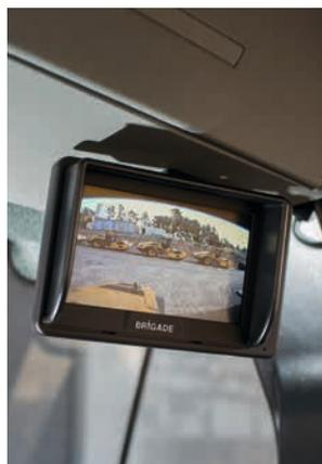
**CAMÉRA DE REcul.** Particulièrement sûre : fixée à l'arrière du rouleau monocylindre et raccordée à un écran couleurs dans la cabine, cette caméra augmente nettement la sécurité d'exploitation.
