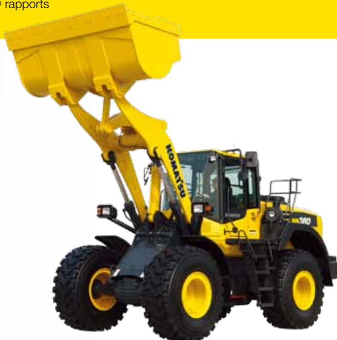
Les ailes intégrales arrière (de série) sont faites de plastique durable et pivotent pour faciliter l'accès aux points d'entretien.
