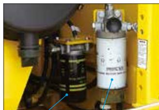
Filtre à carburant haute efficacité    Préfiltre à carburant (avec séparateur d'eau)
