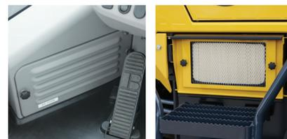
Filtre à air intérieur      Filtre à air extérieur
