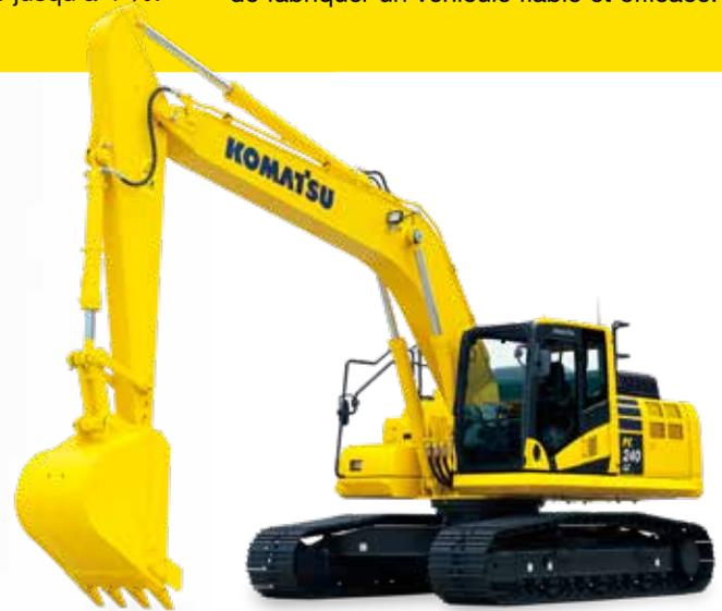
**Un puissant moteur Komatsu SAA6D107E-3** fournit une puissance nette de sortie de 132 kW **177 hp**. Ce moteur est certifié EPA Tier 4 (final) pour le contrôle des émissions polluantes.
