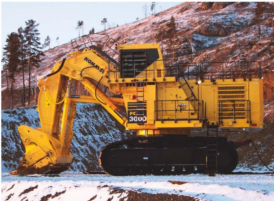
Même sur les chantiers confinés, vous pouvez maintenir une production élevée. La PC3000 est une machine puissante et polyvalente dotée d'une technologie avancée, d'une pelle frontale de 16 m<sup>3</sup> et d'une rétrocaveuse de 15 m<sup>3</sup>, avec une portée suffisante pour remplir les camions de 85 à 165 tonnes courtes.
