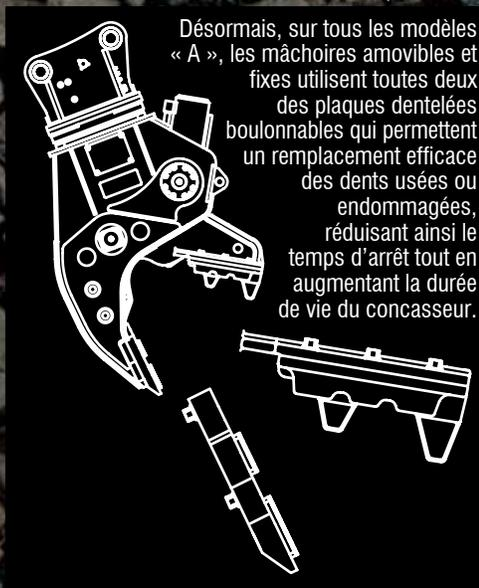
Désormais, sur tous les modèles « A », les mâchoires amovibles et fixes utilisent toutes deux des plaques dentelées boulonnables qui permettent un remplacement efficace des dents usées ou endommagées, réduisant ainsi le temps d'arrêt tout en augmentant la durée de vie du concasseur.
