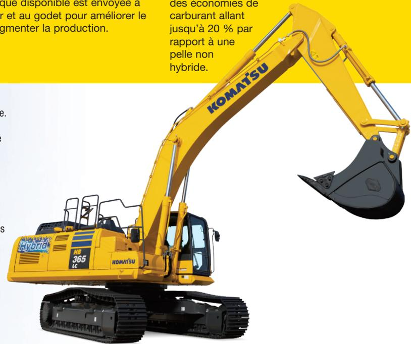
**Le puissant moteur Komatsu SAA6D114E-6** fournit une puissance nette de 201 kW / **269 ch**. Ce moteur est conforme aux normes d'émissions EPA Phase 4 finale.
