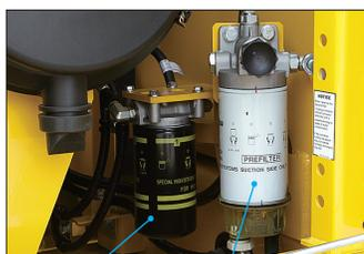
Filtere à carburant haute efficacité      Préfiltere à carburant (avec séparateur d'eau)
