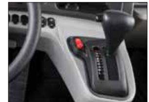
Fonction de saut de rapport : Sélectionne automatiquement une vitesse, en fonction de l'angle de montée. Cela élimine le besoin de passer par chaque vitesse lorsque vous vous déplacez en montée. Il réduit le nombre de rétrogradages, rend la conduite plus fluide, améliore le confort de l'opérateur et réduit le gaspillage de matériau.
