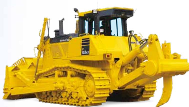
**Le système de direction hydrostatique (HSS)** fournit un contrôle en douceur, rapide et performant dans des conditions de sol différentes. (La contre-rotation est disponible au point mort.)
