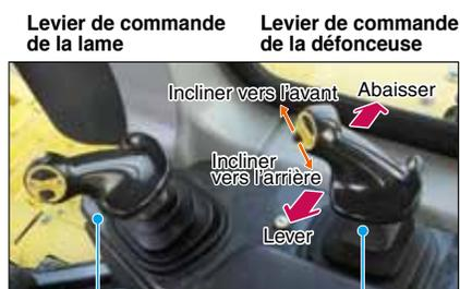
Levier de commande de la lame      Levier de commande de la défonceuse
