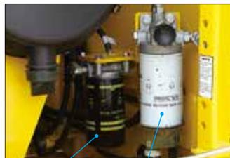
Filtre à carburant haute efficacité    Préfiltre à carburant (avec séparateur d'eau)
