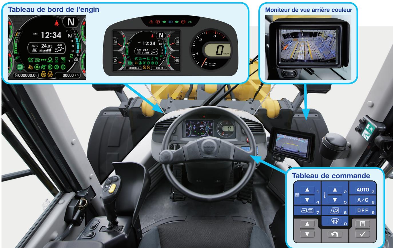
**Système de surveillance de la vue arrière standard**
