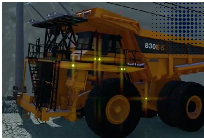
L'avantage de l'assistance par chariot est que l'énergie électrique utilisée pour déplacer le camion de transport est générée à partir d'une source plus propre que le moteur diesel, tout en améliorant la productivité du parc.
