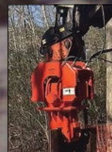
Appareils de battage de palplanche
