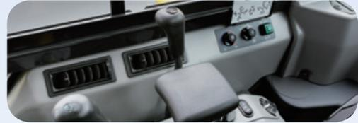
Appareil de chauffage avec évent d'air frais
